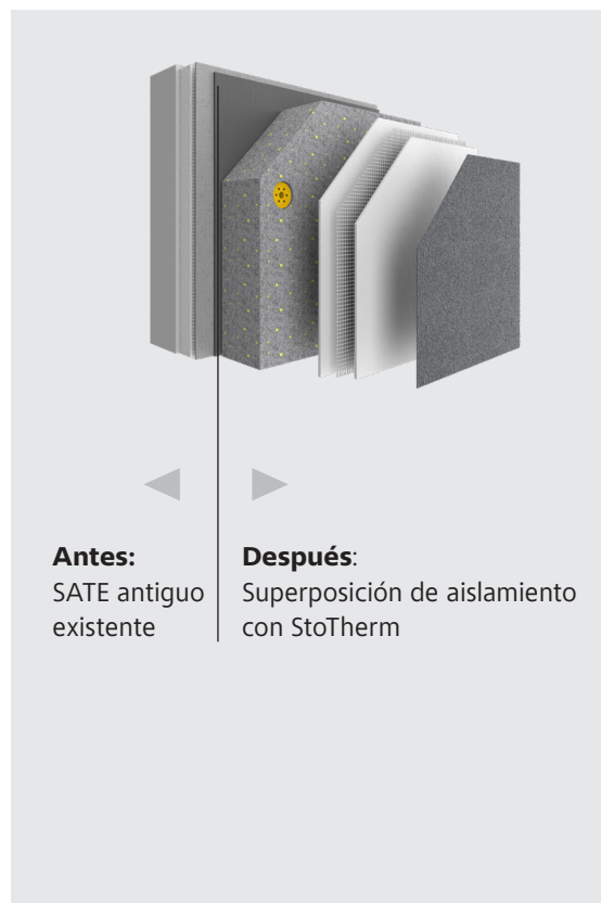
Imagen izquierda: Estructura del antiguo SATE con superposición
