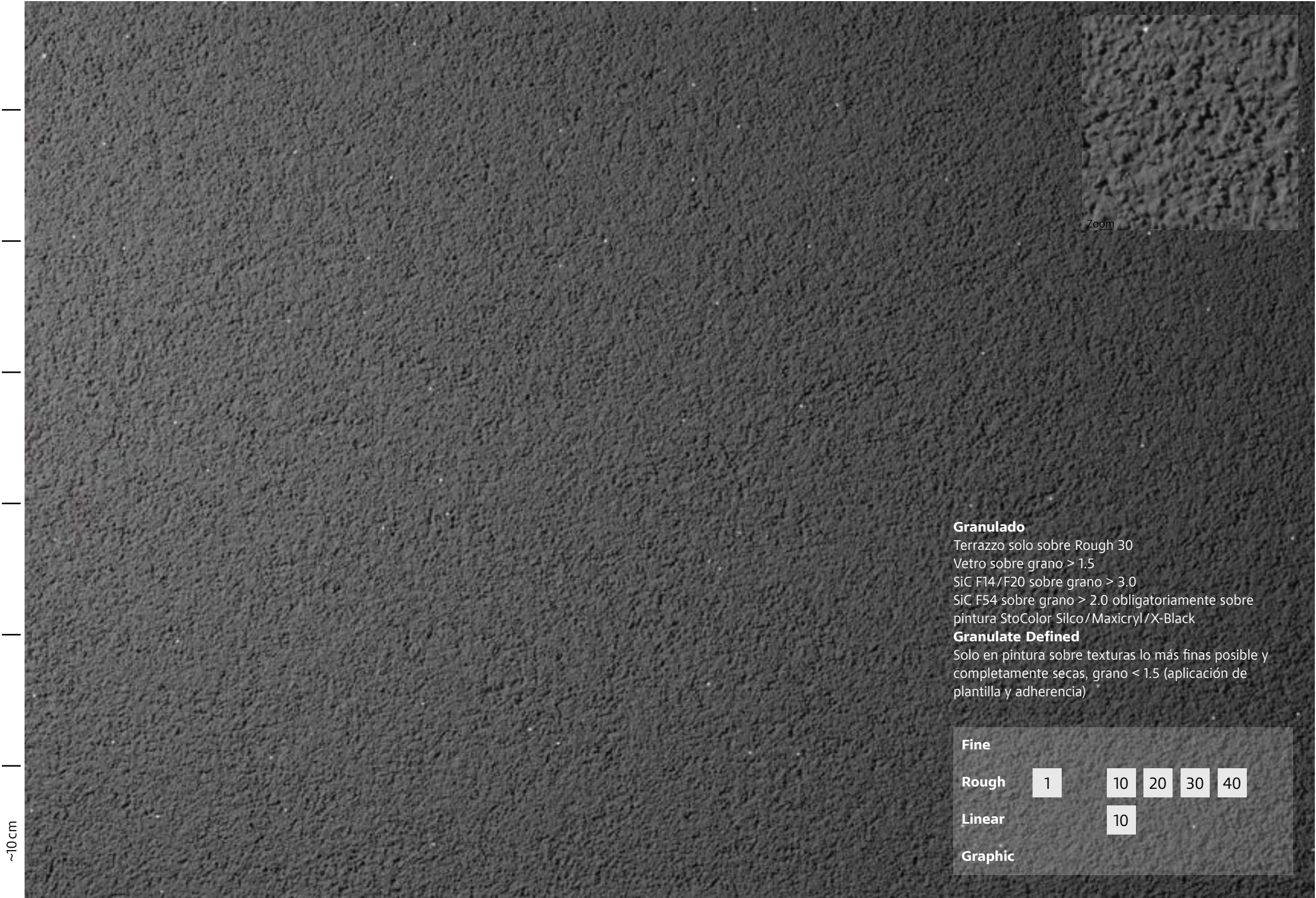
Textura: Rough 1, Stolit K 3.0 (37104) + Efecto: Granulate 20, Sto-Carburo de silicio F20
