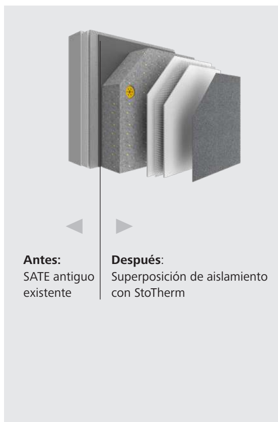
Imagen izquierda: Estructura del antiguo SATE con superposición
